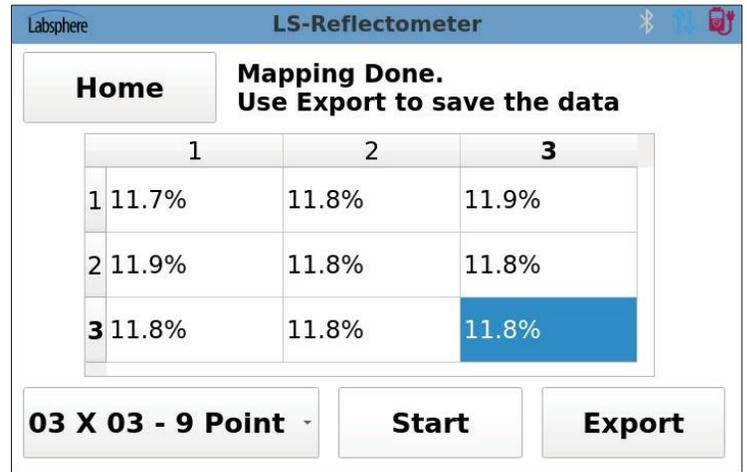
反射率测定仪友好的触摸屏界面使设备校准，数据传输到外部 PC，绘制目标板反射率分布表以及单次扫描测量触手可
