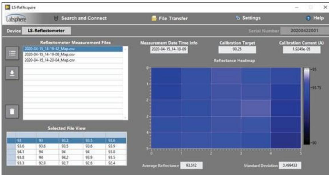
RefAcquire 通过 USB 实时与反射率测定仪硬件配合使用，以提供文件传输，文件维护和数据可视化。RefAcquire 的反射热图创建了一个数据可视化工具，该工具提供了快速高效的方式来快速评估反射率数据。
